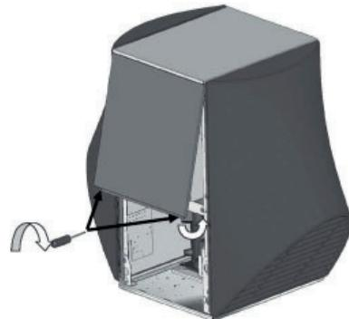
Nyní jsou vodící kryty vzduchu namontovány. Můžete provést montážní a instalacní práce na přístroji a po skončení prací instalovat dolní opláštění. (Viz u „Elektrické připojovací práce“, „Připojení vodičů ovládání a čidla na straně teplného čerpadla“, ⑥).
